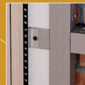
монтажная клипса устанавливается в прорезь под шипом с шагом  $\leq 600$  мм и фиксируется к направляющей через саморез
